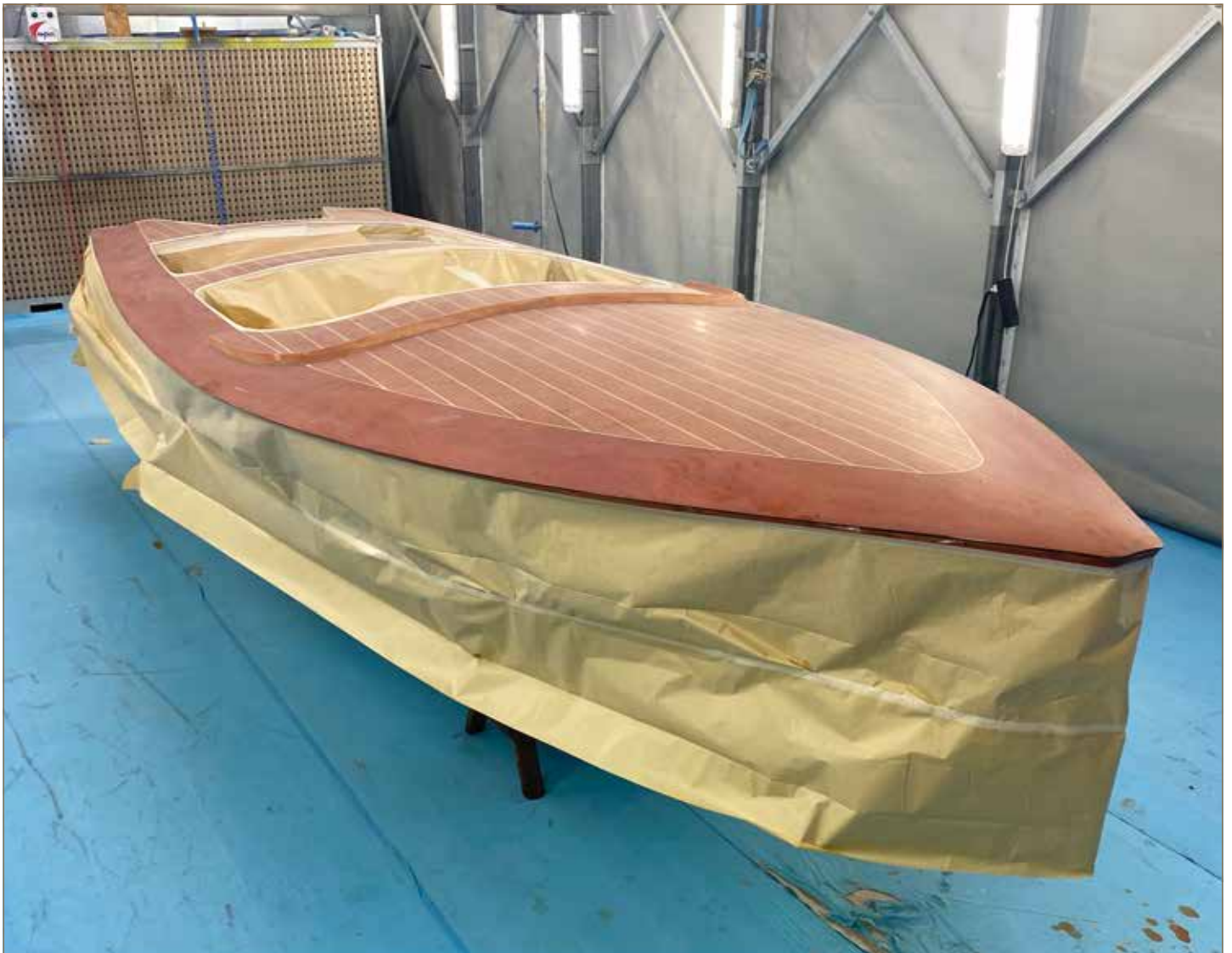
▲ Restauration: un Poncelet des années 60 dans la cabine de peinture
