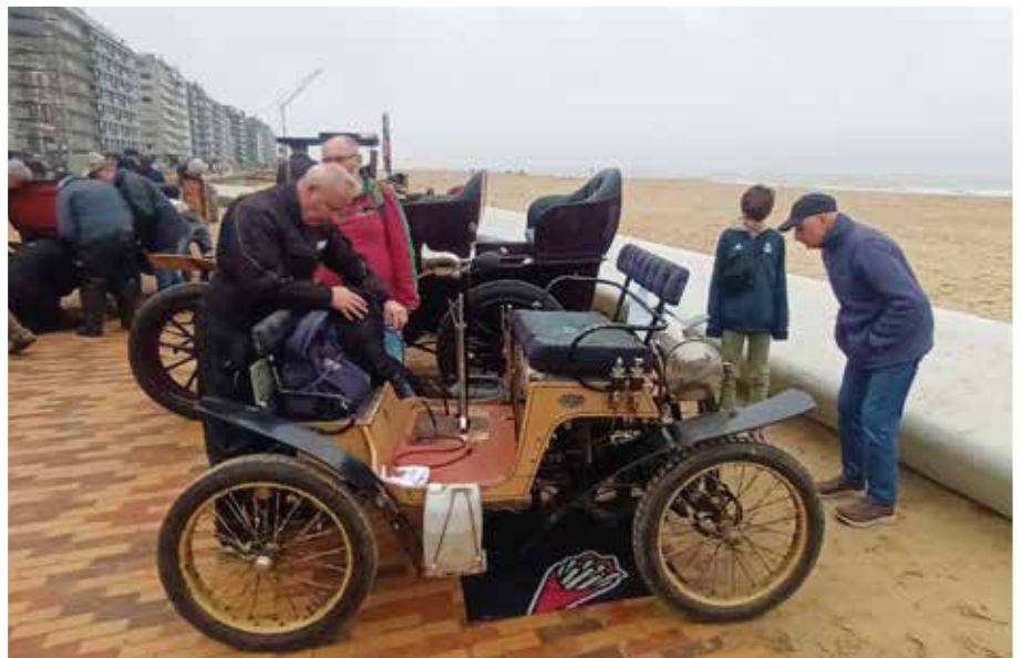
► La Decauville «voiturelle» de 1901, innovante grâce à son moteur bicylindre et son châssis léger
