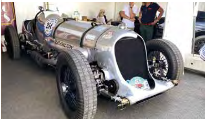
▲ De Napier-Railton werd in 1933 gebouwd voor John Cobb. Hij is aangedreven door een 24 L W-12 Napier vliegtuigmotor die 580 pk levert. Tussen 1933 en 1937 brak hij 43 snelheidsrecords, waaronder ook enkele op het Circuit van Monthléry.
