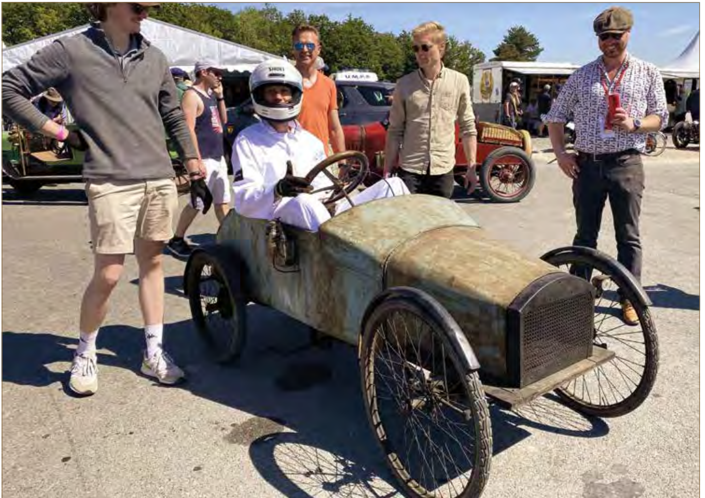
▲ Nicolas van Frausum, organisateur du Concours d'Anvers, avec sa dernière acquisition: une Bontemps Type A 300cc, construite en 1920 par un monsieur du même nom, à Tuffe, dans La Sarthe (F). Il s'agit d'une cyclecar artisanale construite à un seul exemplaire, probablement à partir de pièces hétéroclites. Selon le connaisseur Stany Wouters, le moteur est un F.N. Mono 300cc construit en 1904/1905. Boîte 3 vitesses, volant d'à peu près 1910-1915, et essieu avant provenant d'un triporteur, vraisemblablement d'entre 1898-1900. Et ça roule!
