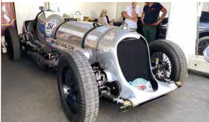
▲ La Napier-Railton a été construite en 1933 pour John Cobb. Elle était équipée d'un moteur d'avion Napier 24L W-12 développant 580 ch. Entre 1933 et 1937, elle a battu 43 records de vitesse, dont plusieurs sur le circuit de Monthléry.
