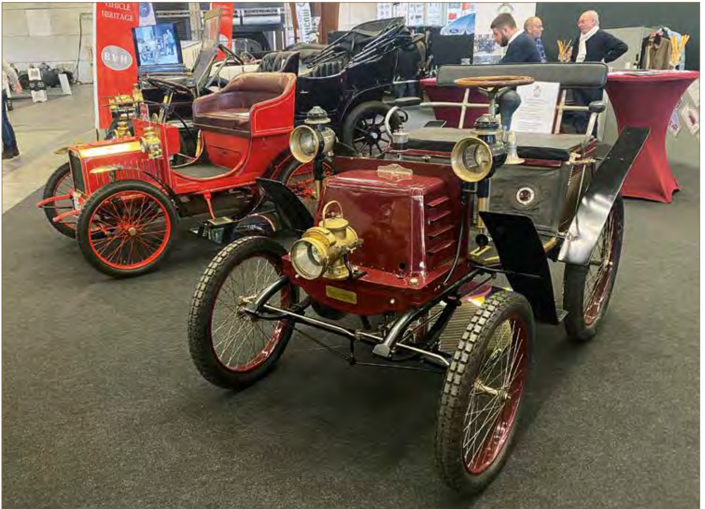
▲ Een Brusselse Vivinus “voiturette” uit 1899 met een luchtgekoelde éencilinder van 708 cc en met 3,5 pk. Daarnaast een Antwerpse Minervette uit 1904 met watergekoelde 636 cc van 5 pk
